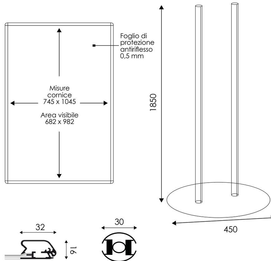
Struttura mono o bifacciale composta da montanti in alluminio anodizzato silver Ø 30 mm con applicate cornici a scatto f.to 700x1000 ad angolo tondo frame 32 mm, complete di fogli di protezione frontale in PVC antiriflesso. Altezza: 1850 mm. Base in metallo verniciato a polveri silver sp. 6 mm Ø 450 mm.
