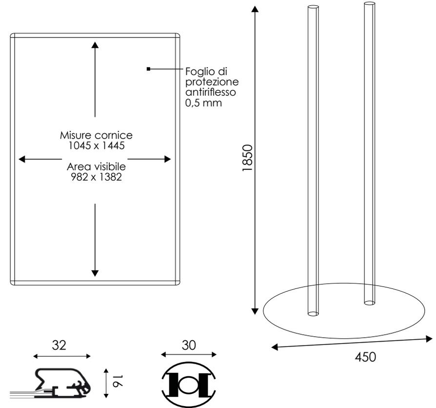
Struttura mono o bifacciale composta da montanti in alluminio anodizzato silver Ø 30 mm con applicate cornici a scatto f.to 1000x1400 ad angolo tondo frame 32 mm, complete di fogli di protezione frontale in PVC antiriflesso. Altezza: 1850 mm. Base in metallo verniciato a polveri silver sp. 6 mm Ø 450 mm.
