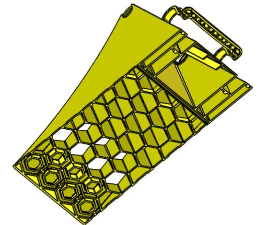
Calzatoia tipologia E53 conforme a DIN 76051 parte 1 e 2
